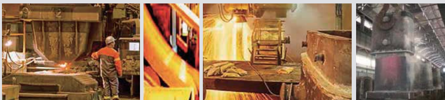
厚度达450毫米的连铸坯，单重达60吨的模锭
